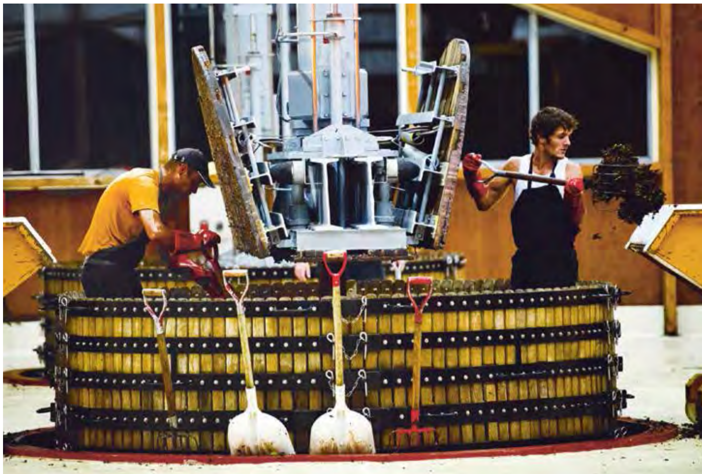
Bei Fleury wird für die Champagner-Herstellung eine traditionelle, mechanische Weinpresse verwendet.
